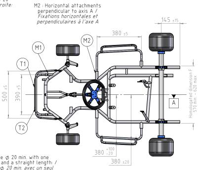
T1: Lower tube Ø 20 min. with one constant radius and a straight length: / Tube inférieur Ø 20 min. avec un seul rayon constant et une partie droite: 270 min.
