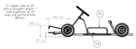
T3: Lower tube Ø 20 with a straight length: / Tube inférieur Ø 20 avec une partie droite: 280 min.
